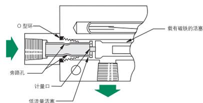
在 Gems FS-926 系列中, 还有一重叠配合型活塞, 用于准确地探测低流量液体。通过低流量活塞底端的一个或多个计量口, 可以进行刻度校准, 调整支路流量, 从而进行动作设置。
